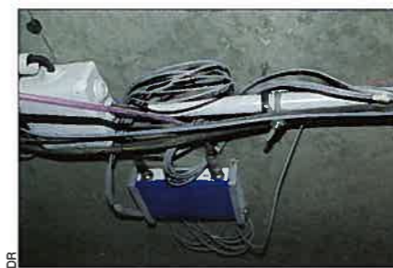
Le système Canhead a été choisi pour son câblage simple et sa proximité par rapport aux points de mesure.
